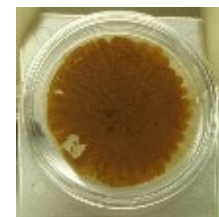
原子炉建屋底部から回収した汚泥
